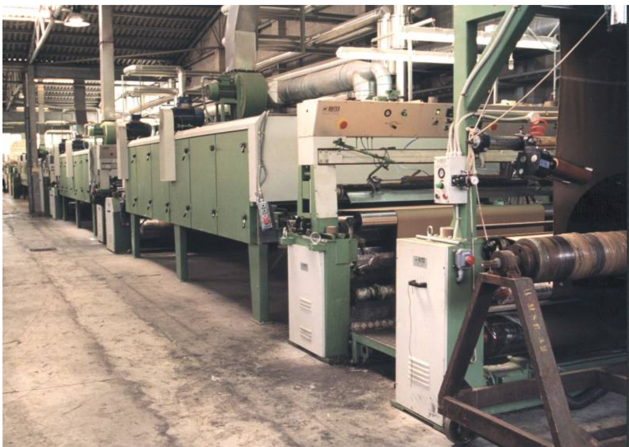
Технологическая линия ROLLMAC от GE.MA.TA. SpA по производству текстильного полотна с разными видами отделочных покрытий
