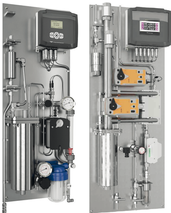
Рис 3. Базовая модель УПП с охлаждением пробы УПП-20МВ (слева) и УПП с до-охлаждающим модулем с использованием элементов Пельтье и системой автоматической стабилизации температуры пробы УПП-20МА (справа).
